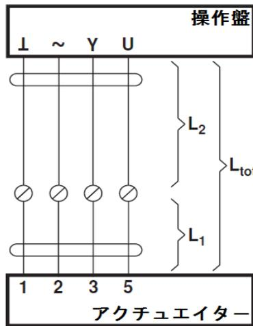
$L_1$ : 標準接続ケーブル 1m ( $0.75\text{mm}^2 \times 4$ )
