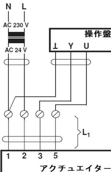
$L_1$ : 標準接続ケーブル 1m ( $0.75\text{mm}^2 \times 4$ )
